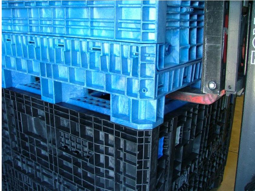
I contenitori devono essere impilati l'uno sopra all'altro in modo da garantire la sicurezza degli operatori ed eliminare il rischio di danneggiamenti. Per impilarlo correttamente, posizionare il contenitore direttamente in cima ad un altro senza farlo scivolare.
