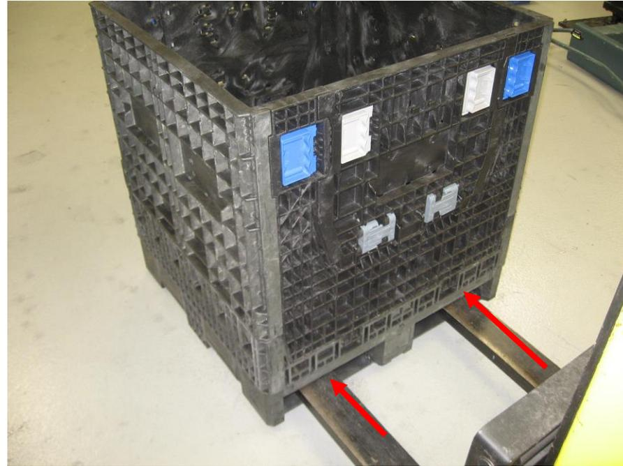
Non far scivolare i contenitori dai denti delle forche. Il carrello elevatore deve fermarsi completamente prima di caricare il contenitore.
