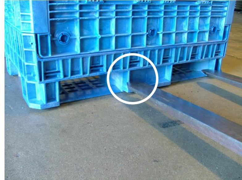
Se i denti delle forche non sono regolati correttamente possono danneggiare la base del contenitore.
