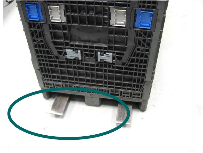
I denti delle forche non devono sporgere oltre la base del contenitore. Ciò può causare danni ad altri contenitori durante l'impilaggio.
