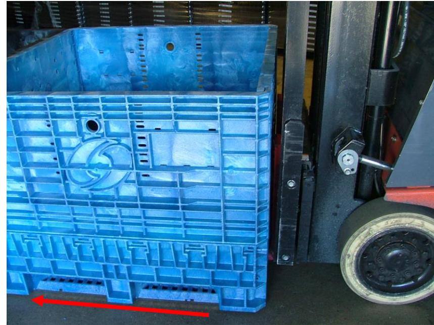
Spingere il contenitore sul pavimento causa dei danni sia al contenitore che all'impianto produttivo.
