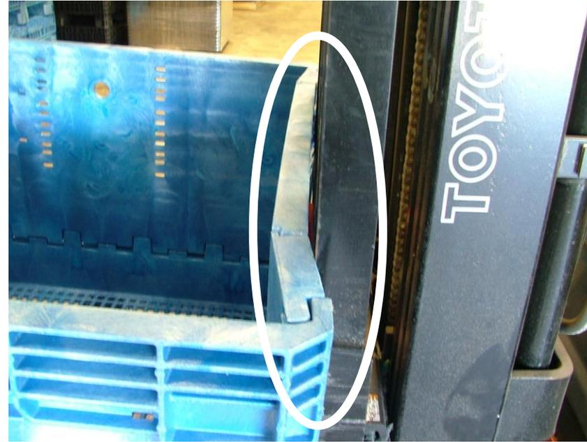
Se il montante non è allineato, la pressione verso l'interno sulle pareti laterali forzerà le aree del fermo del fianco e ne causerà la rottura.
