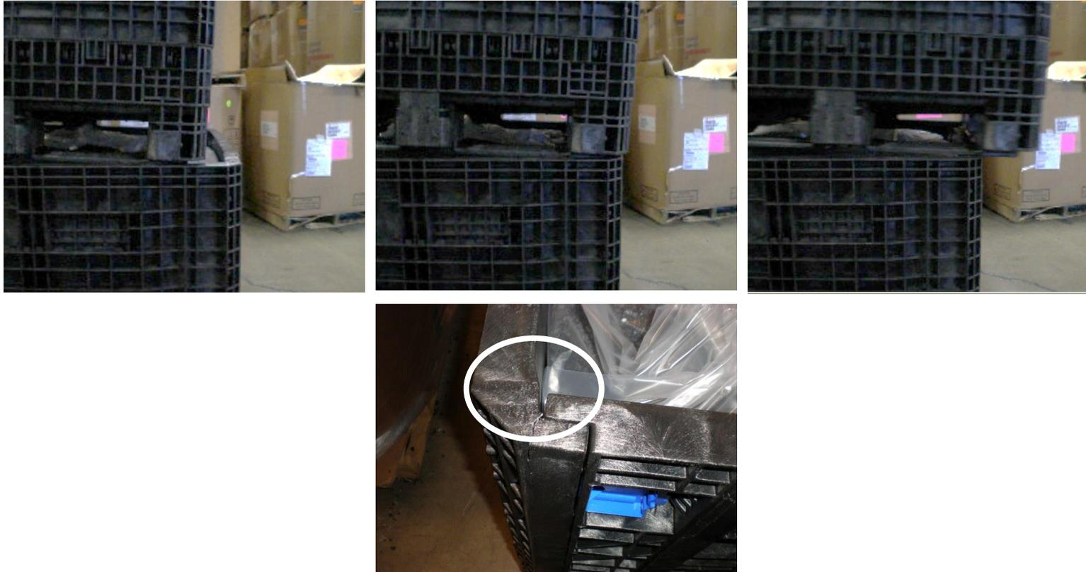
Nell'impilare i contenitori, non usare la parete posteriore del contenitore inferiore per fermare o posizionare quello superiore. Facendo scivolare il contenitore più in alto nella parete posteriore del contenitore sottostante causa il danneggiamento del fianco dell'angolo superiore.
