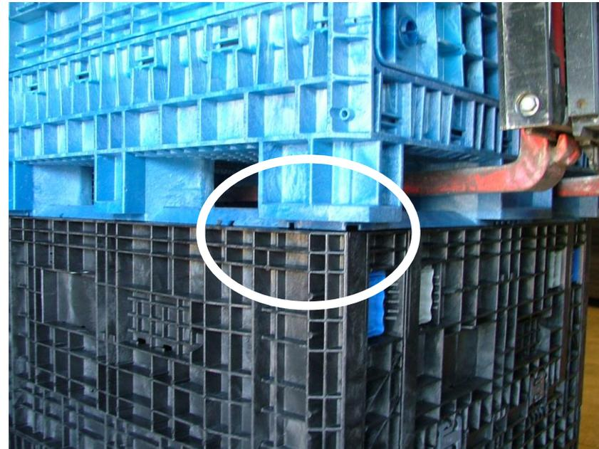
Se non impilati correttamente, i contenitori possono danneggiarsi e cadere mettendo così in pericolo la sicurezza dell'operatore. Assicurarsi sempre di abbinare i lati corretti. (48" non con 45")
