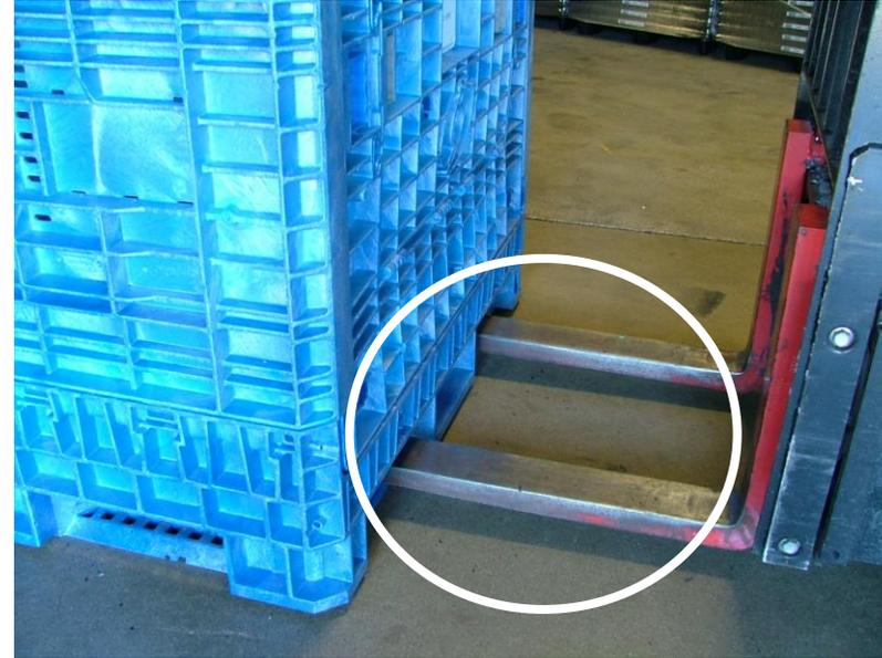
Se le forche non sono completamente sotto il contenitore, aumenta il rischio che il contenitore si inclini e si danneggi.
