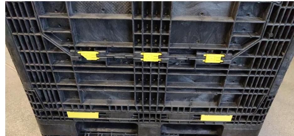
Evitare l'impatto laterale delle porte di accesso aperte. Impattare la porta di accesso dalla parte anteriore con un carrello elevatore può causare danni.
